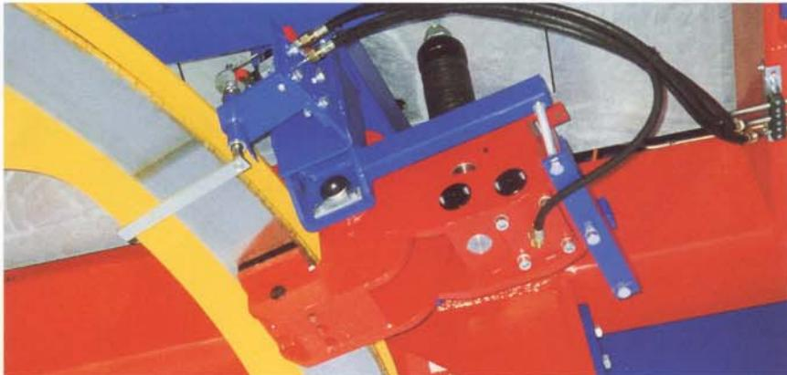
La construction simple du logement de la roue motrice permet un accès très aisément pour les travaux de maintenance et d'entretien. Les paliers de la poulie, indépendants du réducteur, permettent un gain de temps considérable en évitant de détendre les câbles lors de la révision de celui-ci. De plus, les deux étages du réducteur se trouvent sur le châssis de la motrice.
